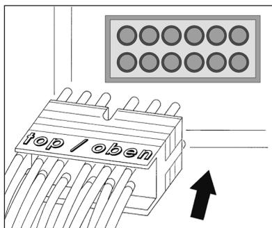
Der Stecker „male“ wird in die Anschlussbuchsen des Steuergerätes gesteckt. Bitte beachten Sie die Kennzeichnung top/oben und bottom/unten auf dem Schlauchstecker.
