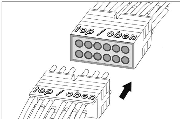
Der Stecker „female“ wird mit dem Schlauchende der Manschette verbunden. Bitte beachten Sie die Kennzeichnung top/oben und bottom/unten auf den beiden Schlauchsteckern und stecken die Stecker so zusammen, dass „oben“ mit „oben“ sowie „unten“ mit „unten“ aufeinander treffen .
